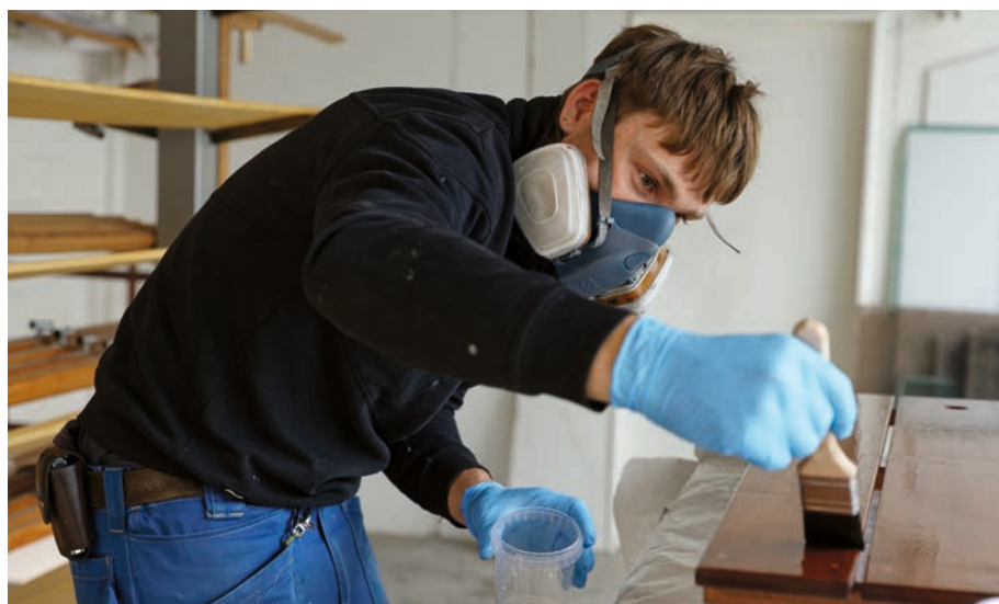
➤ Lors de la pose de vernis, Tim Glauser porte un masque à charbon actif pour protéger ses voies respiratoires.
